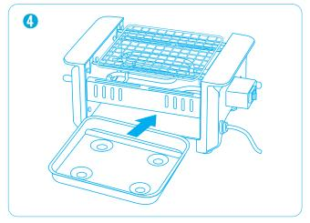
4. 然後將盛油水盤放回燒烤爐裡發熱線下方(注意:注水時切勿將水滴到發熱線上。)
