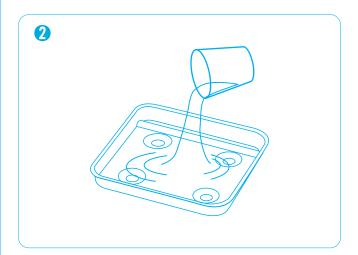
將適量的水加到盛油水盤內並不可 超過注水線,注水時需確保水位保 持在發熱線的下方。
