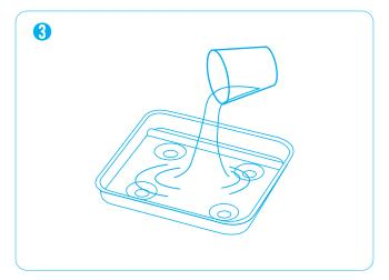
3. 再將適量的水加到盛油水盤內並不可超過注水線,注水時需確保水位保持在發熱線的下方。
