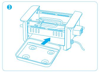
3. 然後將盛油水盤放回燒烤爐裡發熱 線下方(注意:注水時切勿將水滴到 發熱線上。)
