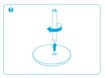
2.把外柱插入底座的圓孔中,並順時針旋轉外柱將外柱鎖緊在底座。(可以選擇安裝一條或兩條外柱)
