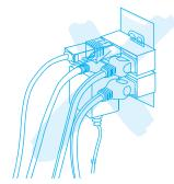
拔除插頭時不可拉扯電源線,必須緊握插頭,把插頭拔出。
