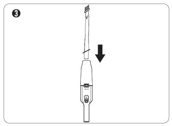
3. 將毛刷吸嘴插入縫隙吸嘴上。毛刷吸 嘴適用於清理座椅墊、腳墊、鍵盤以 及帶有天鵝絨表面的空調出風口等各 種表面的灰塵。
