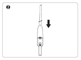
2.將縫隙吸嘴插入吸氣口上。縫隙吸 嘴可以清潔家具縫隙等其他難以清 潔的角落。
