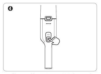
4. 按開/關鍵,電源顯示燈亮起,吸塵機以速度1開始工作。再按開/關鍵轉為速度2,再按開/關鍵關閉吸塵機。
