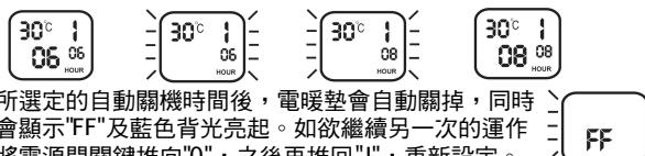
當完成所選定的自動關機時間後，電暖墊會自動關掉，同時顯示屏會顯示"FF"及藍色背光亮起。如欲繼續另一次的運作，請先將電源開關鍵推向"0"，之後再推回"I"，重新設定。
