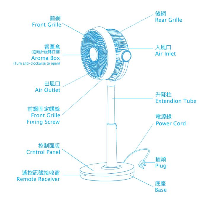
風扇可使用控制面板按鍵操控(如圖 1),或改用遙控器操控。
